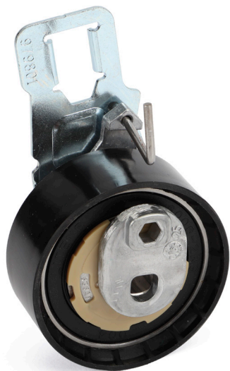
Figura 1: Versione precedente con superficie di scorrimento in plastica
